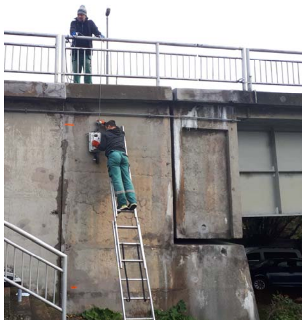
Obr. 11. Ukázka diagnostiky konstrukce v místě dilatační spáry georadarem RAMAC GX s anténním systémem 750MHz.
