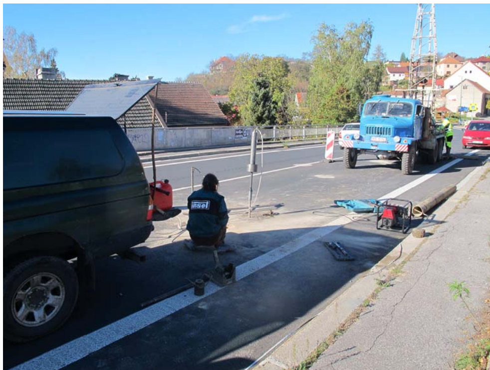
Obr. 8. Provádění dynamické penetrace DP3.
